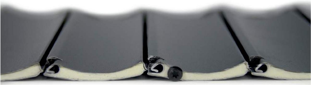
Die Kunststoffschraube aus dem Material PTFE dient als Abstandshalter zwischen dem Nutengrund der Führungsschiene und dem Rollladenprofil, wodurch sich eine optimale und geräuscharme Führung der Profile ergibt.
