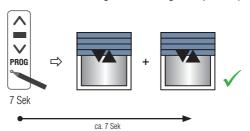
Der Antrieb ist nun auf Werkseinstellung zurückgesetzt und muss neu programmiert werden.
